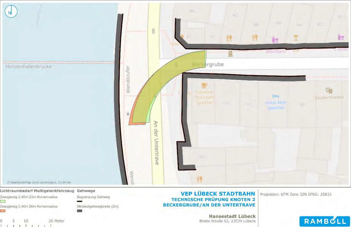
Abbildung 40: Knoten Beckergrube/An der Untertrave - 7. Variante: Multigelenkfahrzeug 2,40 m Breite, zweigleisige Führung (Trassenbreite von 6,8 m bei 25 m Radius und 6,9 m bei 23 m Radius)
