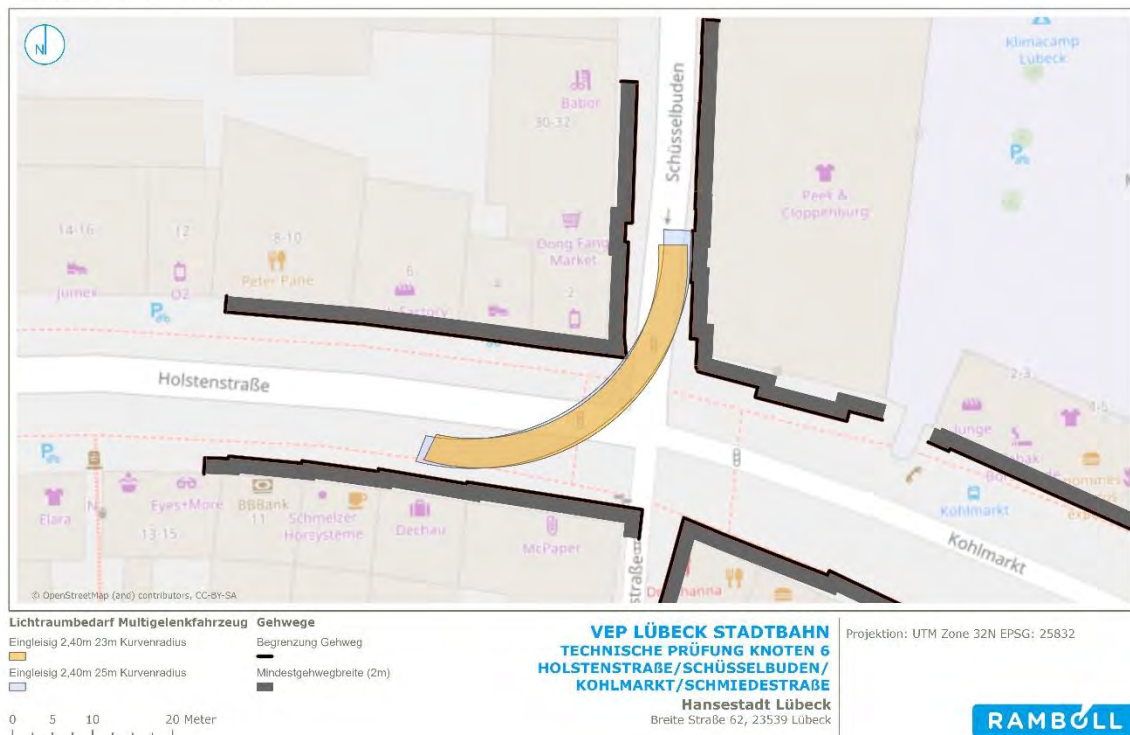
Abbildung 60: Knoten Holstenstraße/Schüsselbuden/Kohlmarkt/Schmiedestraße – Variante 8: Multigelenkfahrzeug 2,40 m Breite, eingleisige Führung (Trassenbreite von 3,45 m bei 25 m Radius und 3,50 m bei 23 m Radius)
