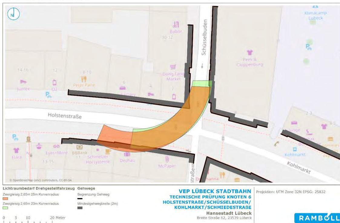
Abbildung 53: Knoten Holstenstraße/Schüsselbuden/Kohlmarkt/Schmiedestraße – 1. Variante: Drehgestellfahrzeug 2,65 m Breite, zweigleisige Führung (Trassenbreite von 7,9 m bei 25 m Radius und 8,00 m bei 23 m Radius)
