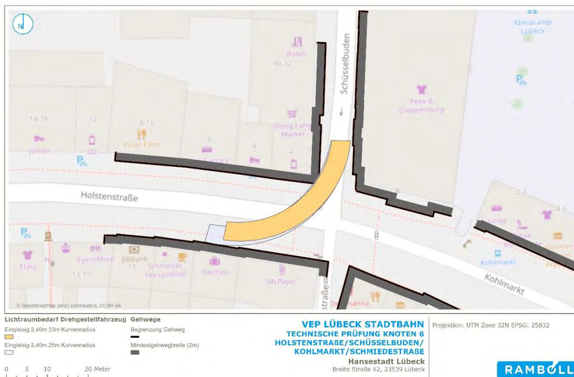
Abbildung 58: Knoten Holstenstraße/Schüsselbuden/Kohlmarkt/Schmiedestraße - Variante 6: Drehgestellfahrzeug 2,40 m Breite, eingleisige Führung (Trassenbreite von 4,45 m bei 25 m Radius und 4,55 m bei 23 m Radius)
