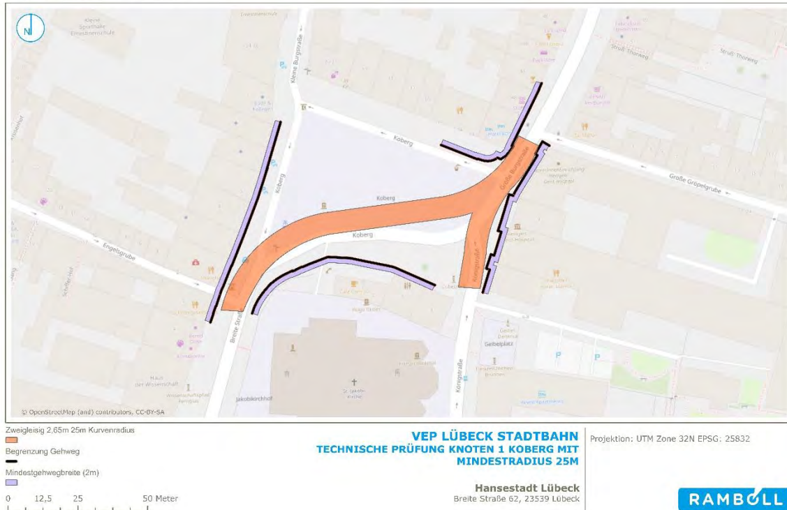
Abbildung 34: Knoten Koberg – 1. Variante: Drehgestellfahrzeug 2,65 m Breite, zweigleisige Führung (Trassenbreite 7,9 m bei 25 m Radius)
