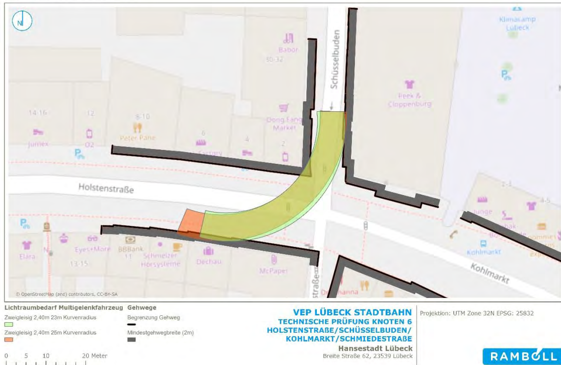
Abbildung 59: Knoten Holstenstraße/Schüsselbuden/Kohlmarkt/Schmiedestraße – Variante 7: Multigelenkfahrzeug 2,40 m Breite, zweigleisige Führung (Trassenbreite von 6,80 m bei 25 m Radius und 6,90m bei 23m Radius)
