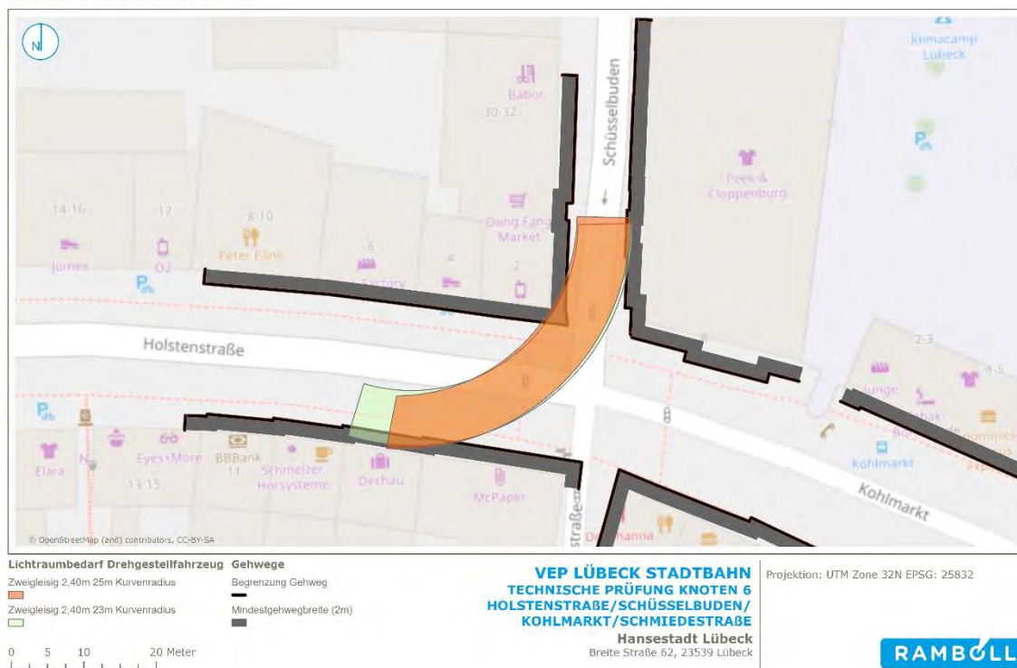
Abbildung 57: Knoten Holstenstraße/Schüsselbuden/Kohlmarkt/Schmiedestraße - Variante 5: Drehgestellfahrzeug 2,40 m Breite, zweigleisige Führung (Trassenbreite von 7,4 m bei 25 m Radius und 7,5 m bei 23 m Radius)
