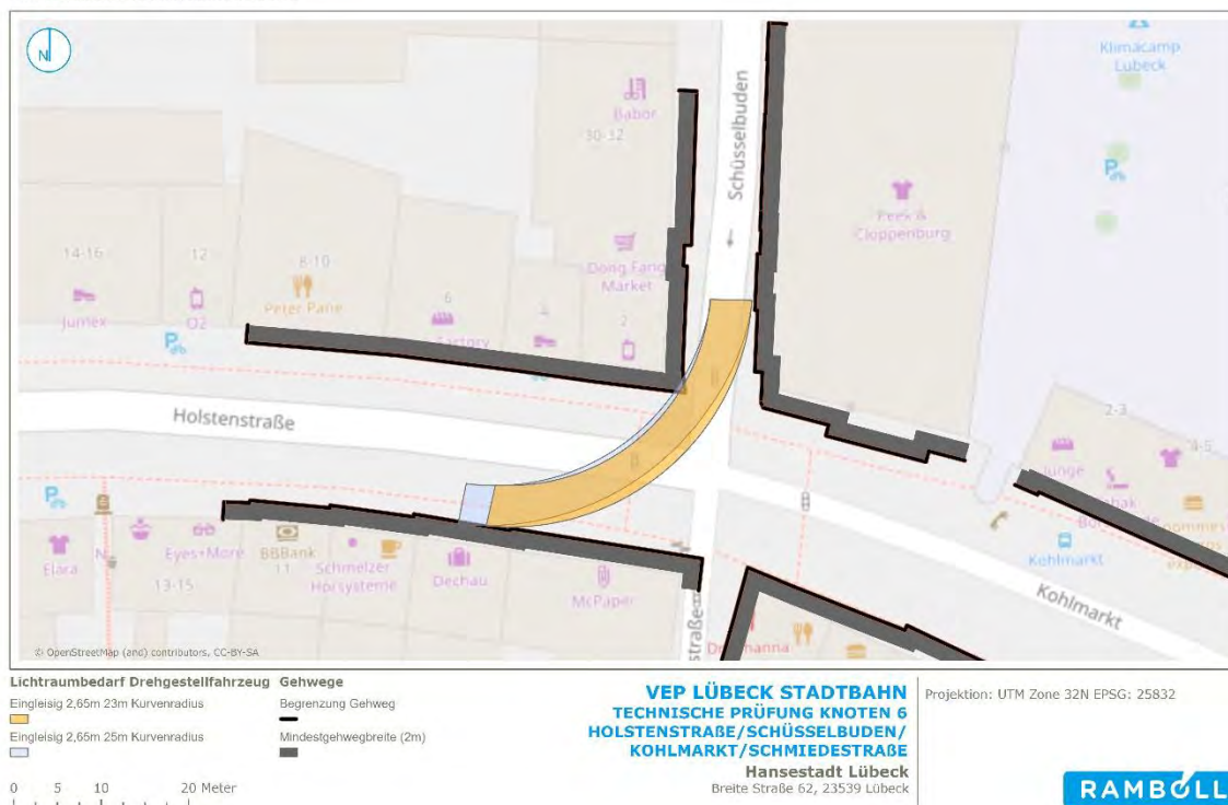
Abbildung 54: Knoten Holstenstraße/Schüsselbuden/Kohlmarkt/Schmiedestraße – 2. Variante: Drehgestellfahrzeug 2,65 m Breite, eingleisige Führung (Trassenbreite von 4,70 m bei 25 m Radius und 4,80 m bei 23 m Radius)
