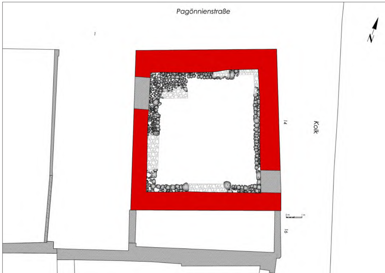
Abb. 5 Mauerwerk und Fundament des Steinwerks Kolk 14 (Plan: K. Siegfried und D. Fuchs auf Basis der Befunddokumentation HL 244).
