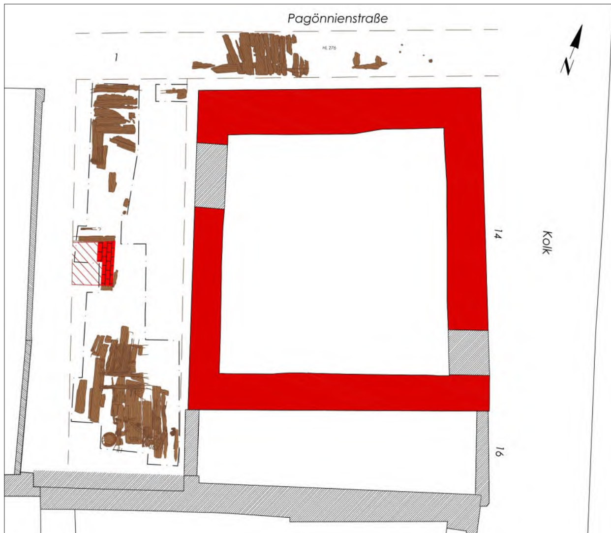
Abb. 10 Kolk 14, Bohlenweg im Norden und stegartige Holzkonstruktion mit Entwässerungsrinnen auf der Westseite (Plan: K. Siegfried und D. Fuchs auf Basis der Befunddokumentation HL 244 / HL 276).
