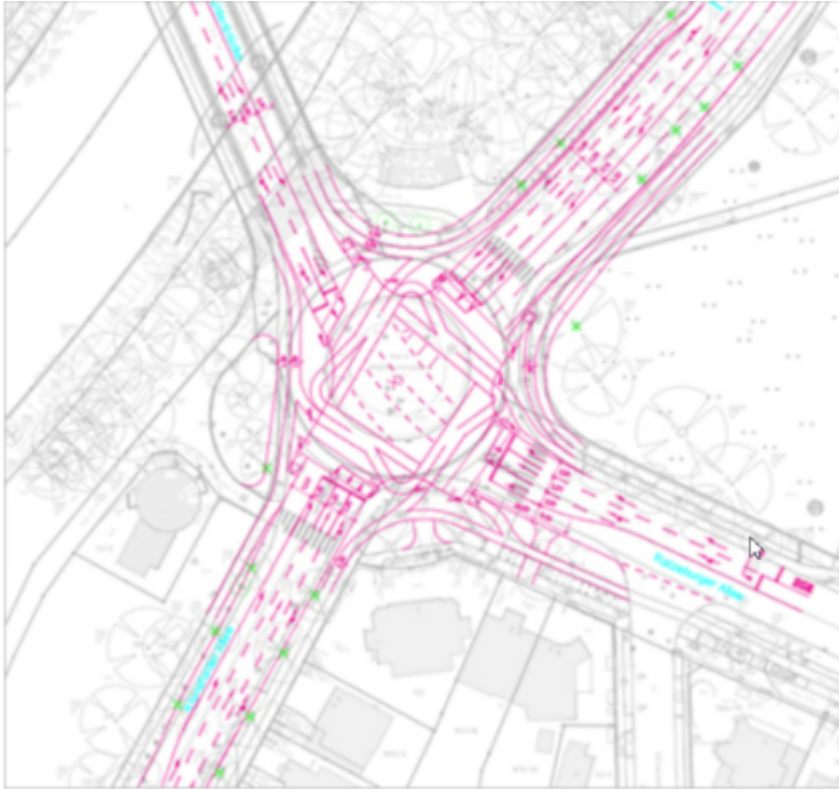
Modifizierte Variante 2: Kreuzungsknotenpunkt mit Lichtsignalanlage
