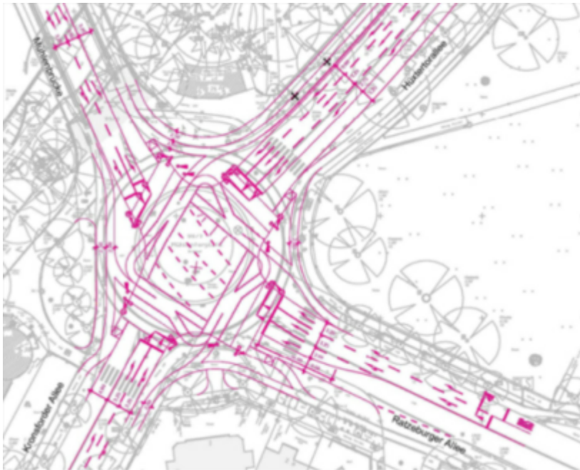
Variante 2: Kreuzungsknotenpunkt mit Lichtsignalanlage
