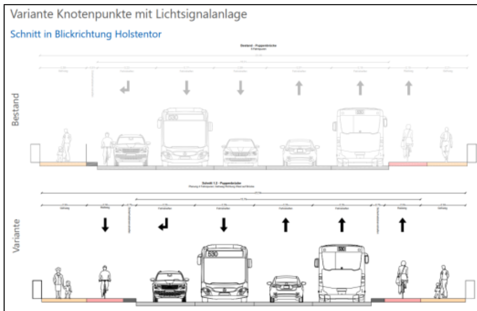
Abb. 6 Knotenpunkt mit LSA Ausschnitt Querschnitt Puppenbrücke
