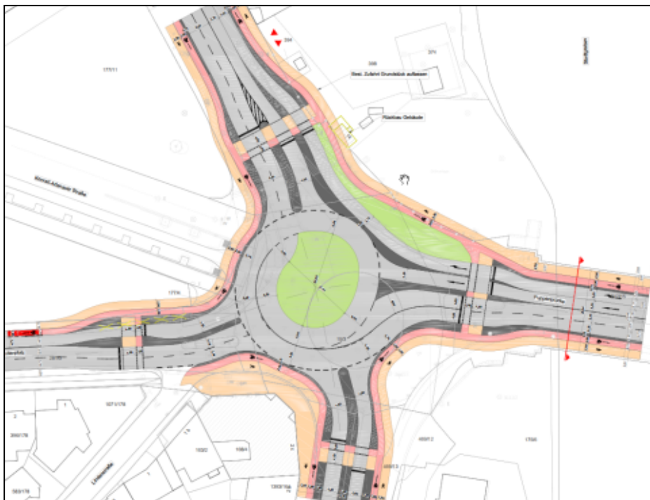
Abb. 7 (Turbo-)Kreisverkehr mit Lichtsignalanlage
