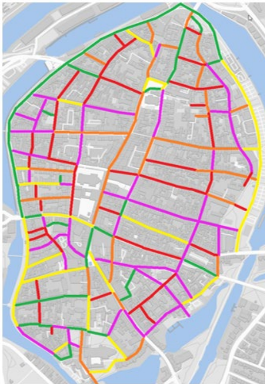
Abbildung 45: Ergebnis der technischen Voruntersuchung im Hinblick auf die Verlegung von Fernwärmeleitungen auf der Lübecker Altstadt-Insel. Grün repräsentiert Straßenabschnitte ohne Einschränkungen bei der Verlegung, rot dagegen Abschnitte, die nach heutigem Stand nur sehr unwahrscheinlich, wenn nicht unmöglich zentral mit Wärme versorgt werden können. Wichtig: Diese Auswertung basiert auf kartierten Verlegesituationen und kann daher nur als grobe Orientierung dienen. Quelle: Stadtwerke Lübeck
