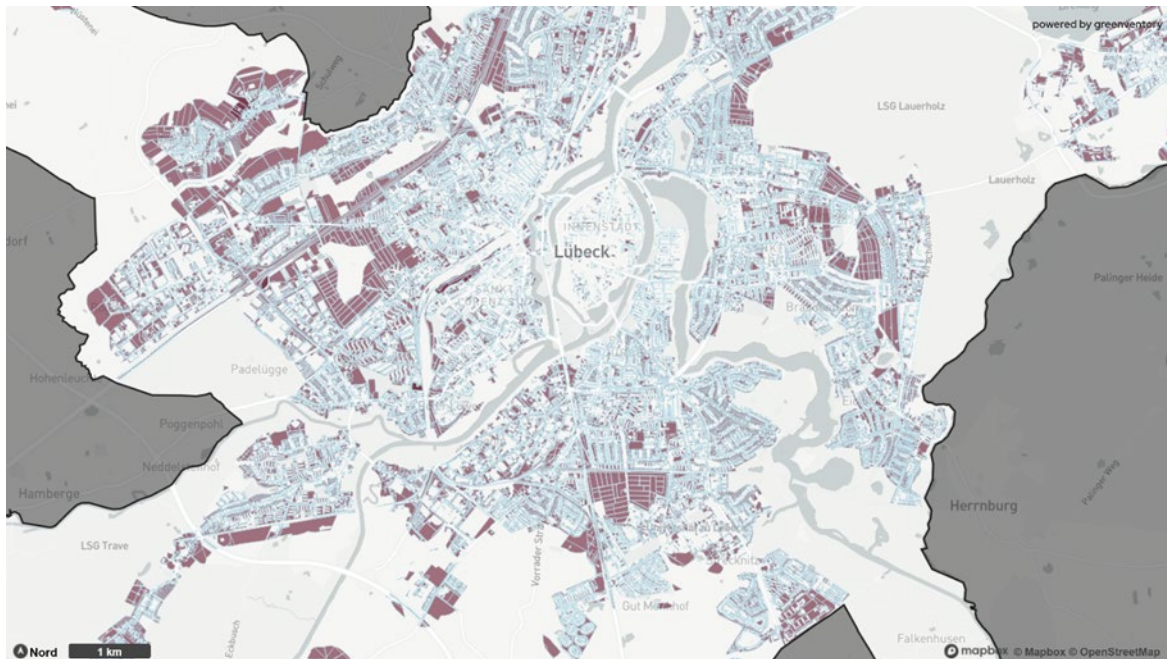
Abbildung 27: Kartenausschnitt mit Eignungsflächen für Erdwärmesonden (Grundstücksgrenzen in hellblau). Besonders interessant: große Flächen in den innenstadtnahen Stadtbezirken für die Einspeisung in Wärmenetze, gerade im Gebiet „Marli-Heiweg“.
