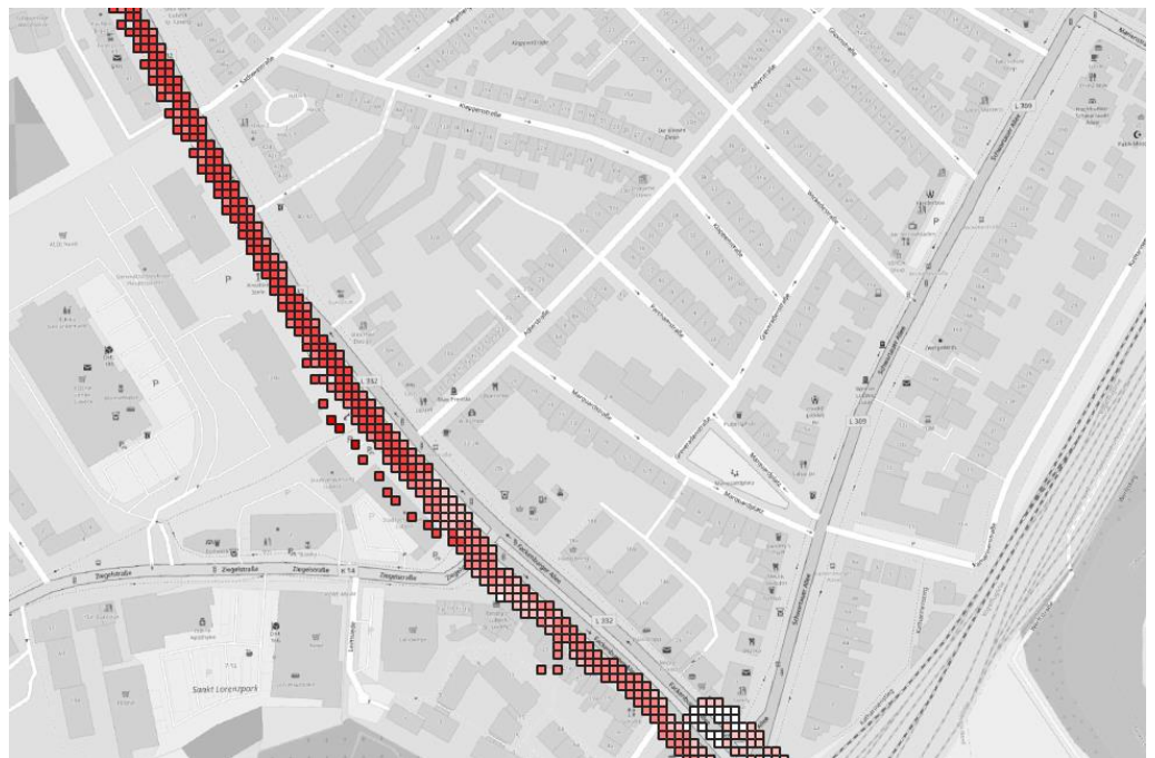
Abb. 61 Durchschnittliche Radverkehrsgeschwindigkeit entlang der Fackenburger Allee Süd in Richtung stadteinwärts (während Versuchsphase)
