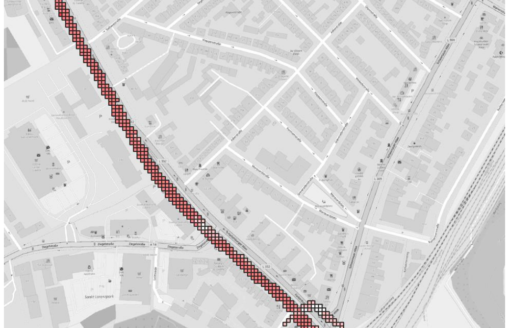
Abb. 60 Durchschnittliche Radverkehrsgeschwindigkeit entlang der Fackenburger Allee Süd in Richtung stadteinwärts (vor Versuchsphase)
