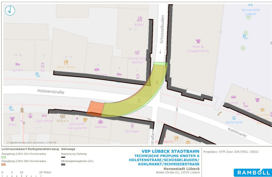
Abbildung 55: Knoten Holstenstraße/Schüsselbuden/Kohlmarkt/Schmiedestraße – 3. Variante: Multigelenkfahrzeug 2,65 m Breite, zweigleisige Führung (Trassenbreite von 7,30 m bei 25 m Radius und 7,40m bei 23m Radius)
