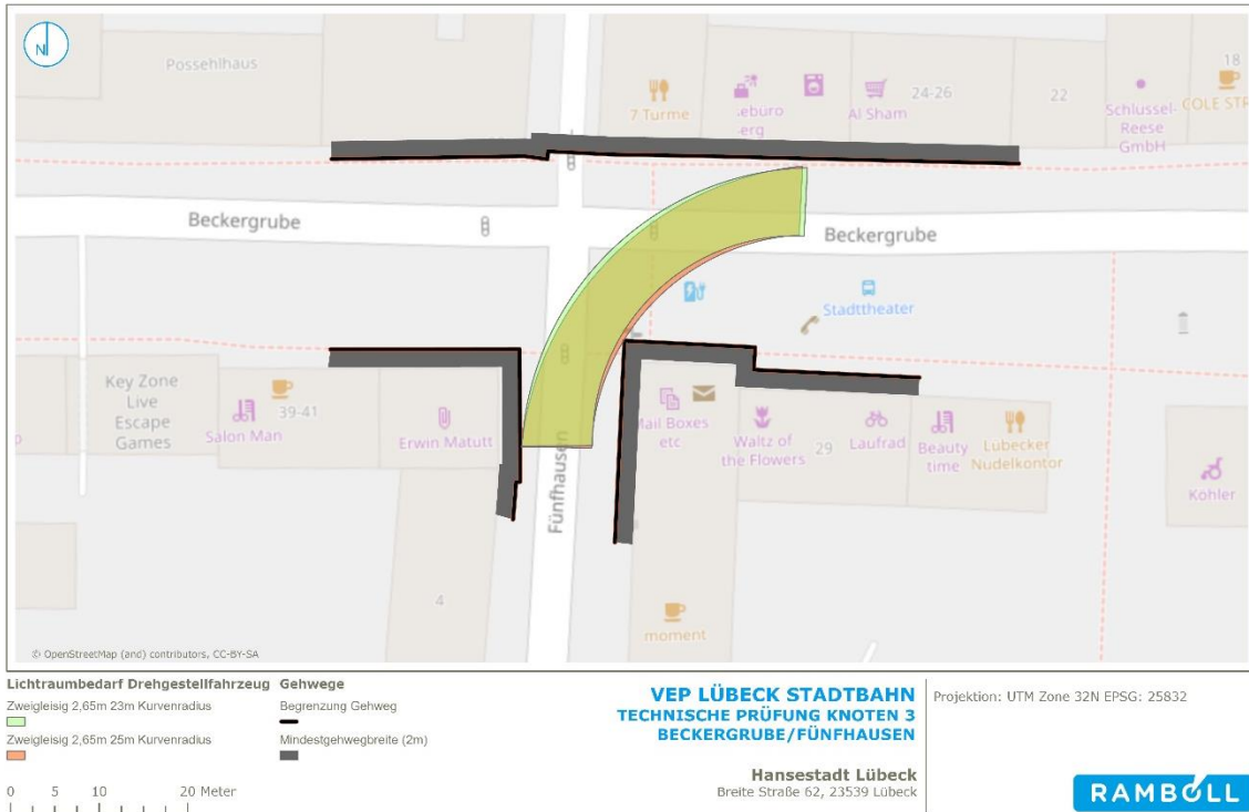
Abbildung 42: Knoten Beckergrube/Fünfhausen – 1. Variante: Drehgestellfahrzeug 2,65 m Breite, zweigleisige Führung (Trassenbreite von 7,9 m bei 25 m Radius und 8,00 m bei 23 m Radius)
