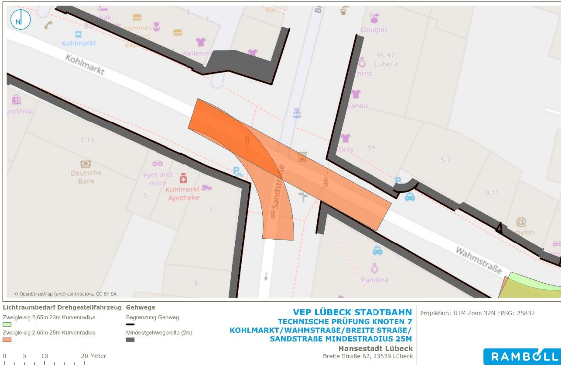
Abbildung 61: Knoten Kohlmarkt/Wahmstraße/Breite Straße/Sandstraße – 1. Variante: Drehgestellfahrzeug 2,65 m Breite, zweigleisige Führung (Trassenbreite von 7,9 m bei 25 m Radius und 8,00 m bei 23 m Radius)
