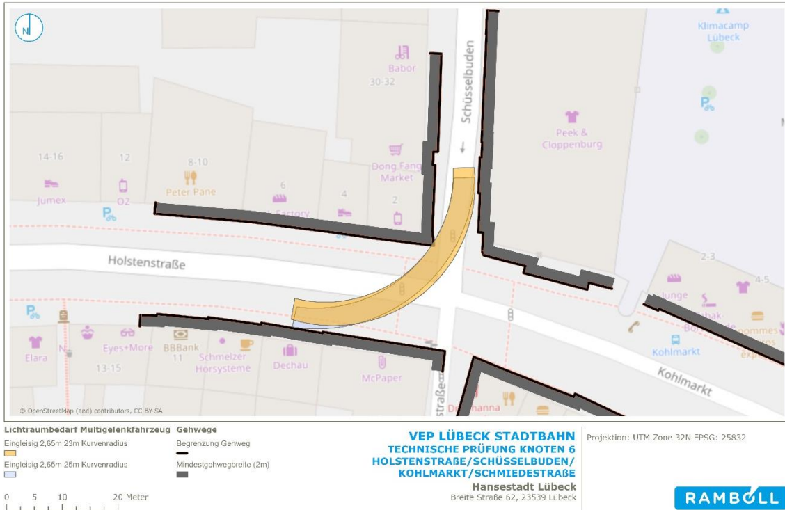
Abbildung 56: Knoten Holstenstraße/Schüsselbuden/Kohlmarkt/Schmiedestraße – 4. Variante Multigelenkfahrzeug 2,65 m Breite, eingleisige Führung (Trassenbreite von 3,70 m bei 25 m und 3,80 m bei 23 m Radius)
