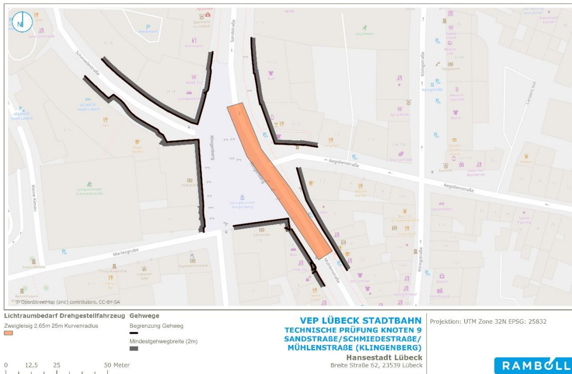
Abbildung 67: Knoten Sandstraße/Schmiedestraße/Mühlenstraße (Klingenberg) – 1. Variante: Drehgestellfahrzeug 2,65 m Breite, zweigleisige Führung (Trassenbreite von 7,9 m bei 25 m Radius)
