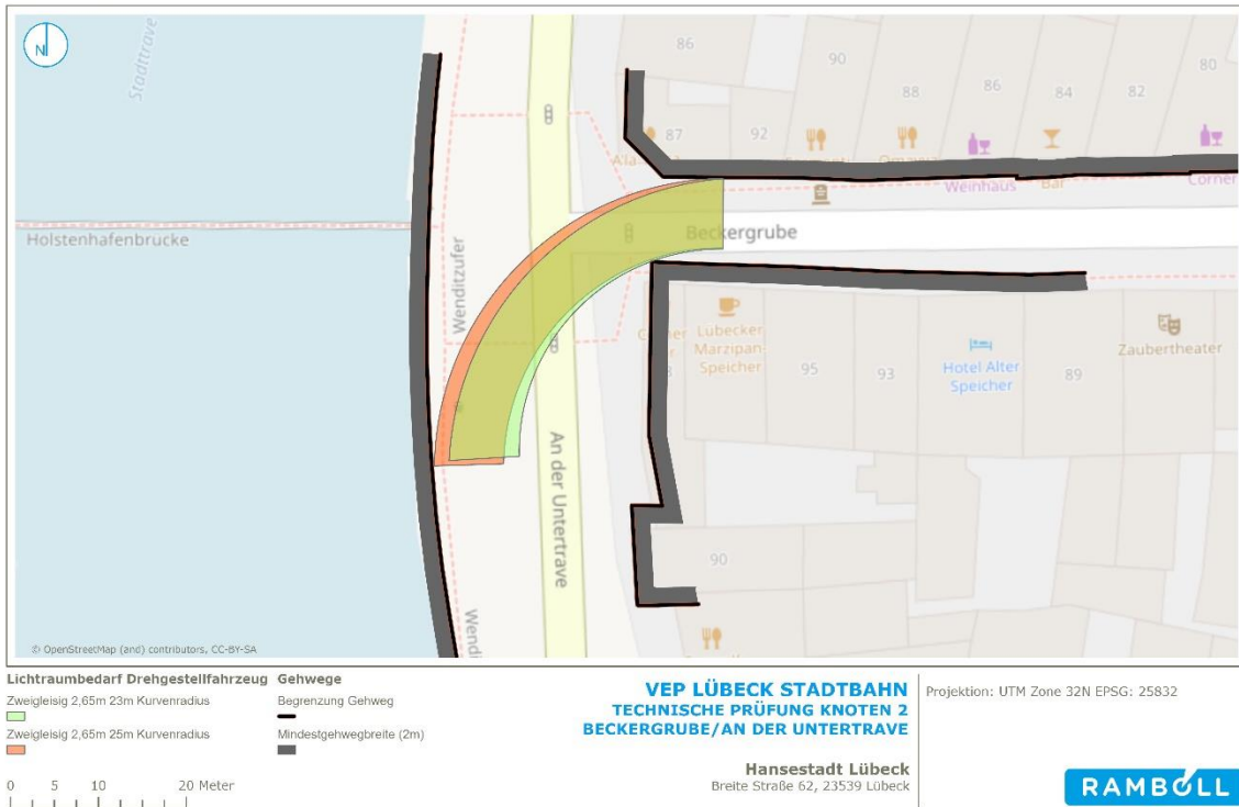
Abbildung 35: Knoten Beckergrube/An der Untertrave - 1. Variante: Drehgestellfahrzeug 2,65 m Breite, zweigleisige Führung (Trassenbreite von 7,9 m bei 25 m Radius 8,00 m bei 23 m Radius)
