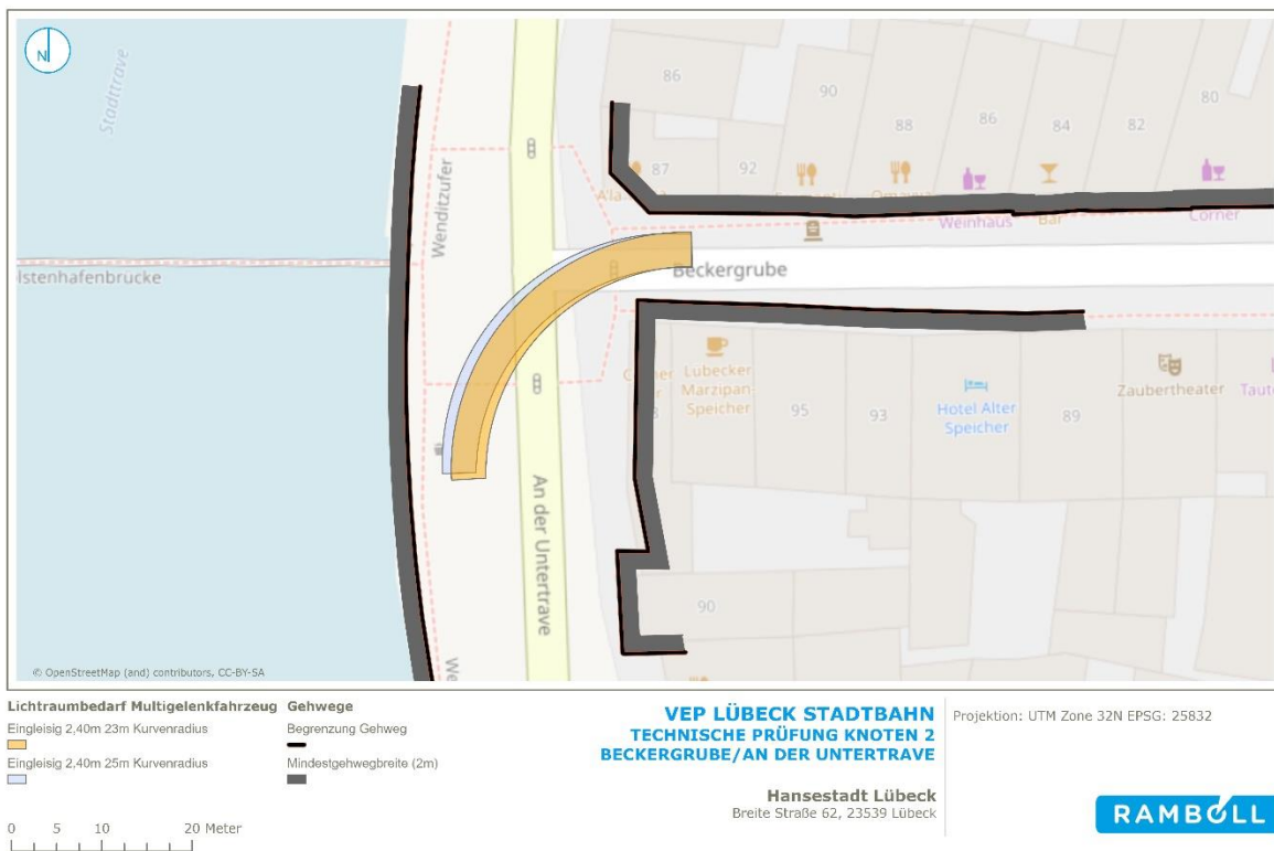
Abbildung 41: Knoten Beckergroße/An der Untertrave - Variante 8: Multigelenkfahrzeug 2,40 m Breite, eingleisige Führung (Trassenbreite von 3,70 m bei 25 m Radius und 3,80 m bei 23 m Radius)
