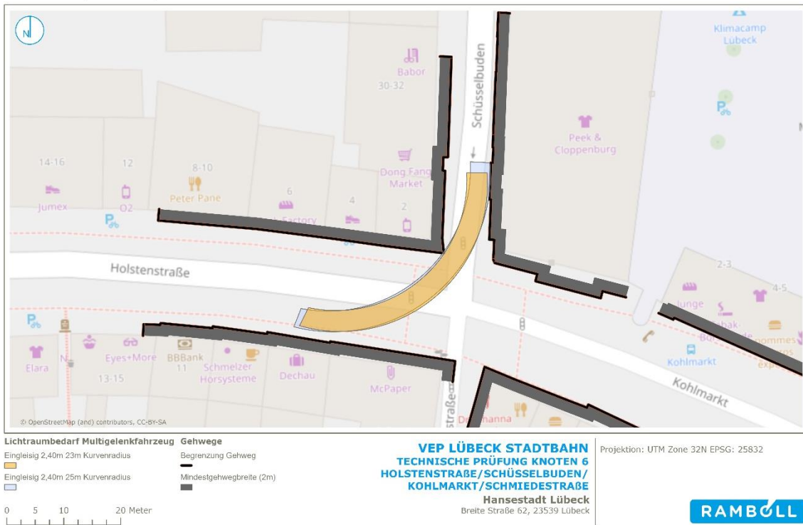
Abbildung 60: Knoten Holstenstraße/Schüsselbuden/Kohlmarkt/Schmiedestraße – Variante 8: Multigelenkfahrzeug 2,40 m Breite, eingleisige Führung (Trassenbreite von 3,45 m bei 25 m Radius und 3,50 m bei 23 m Radius)
