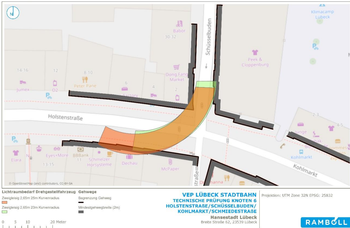
Abbildung 53: Knoten Holstenstraße/Schüsselbuden/Kohlmarkt/Schmiedestraße – 1. Variante: Drehgestellfahrzeug 2,65 m Breite, zweigleisige Führung (Trassenbreite von 7,9 m bei 25 m Radius und 8,00 m bei 23 m Radius)
