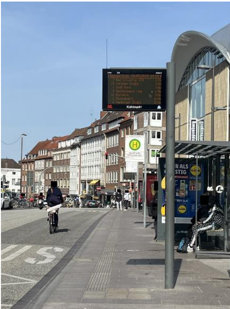
Abbildung 18 Haltestelle mit DFI-Anlage und Außenansage für Sehbehinderte (Quelle: Aufnahme Ramboll)
