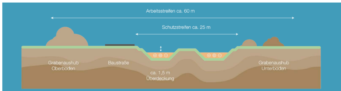
Abb. 1: Offene Bauweise (Quelle: Tennet TSO GmbH/50 Hertz GmbH)
