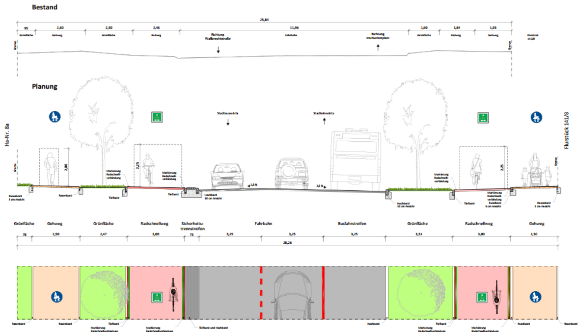
Abbildung 5: Querschnitt 1-1 in Höhe Ratzeburger Allee 8a
