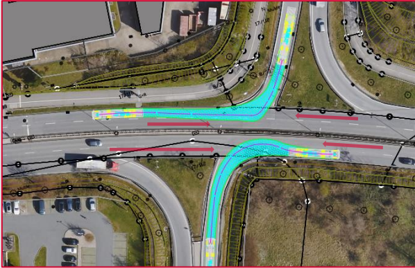
Schleppkurven von der Autobahn
