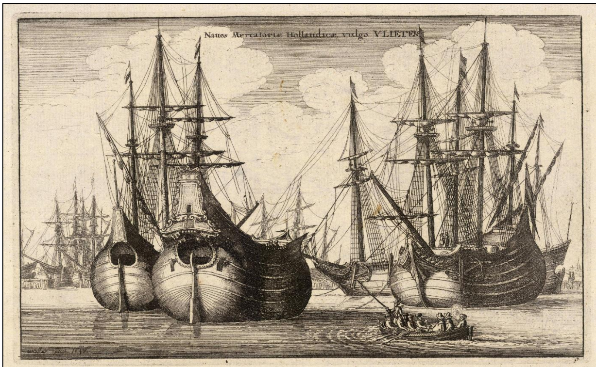
Abb. 8: Holländische Fleuten. Deutlich sind das birnenförmige Heck und das schmale Deck zu erkennen (Radierung von Wenzel Hollar um 1647).
