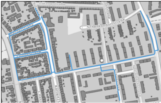
Abbildung 3 und 4 - Breitbandausbau findet in den Gehwegen statt
