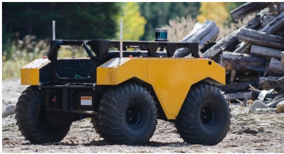
Abb. 1: exemplarisches UGV (5G tauglich) – Sensorik und Kamerasysteme fehlen
