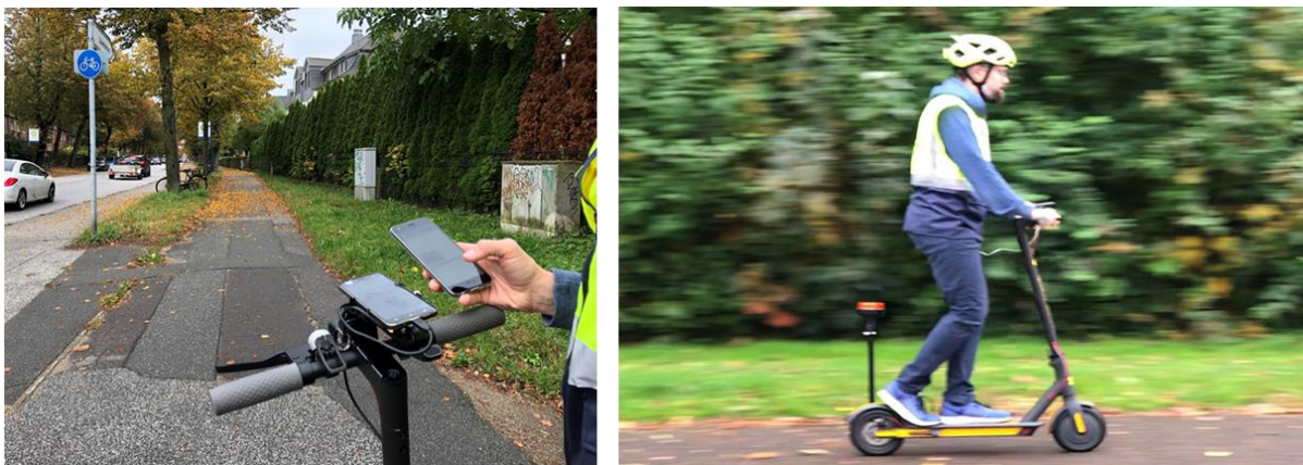
Bild 20 Kleinmessfahrzeug auf der Basis eines E-Scooters
