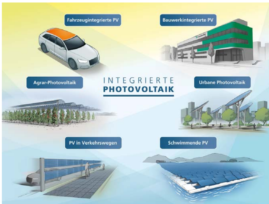
Abbildung 30: Anwendungen für die Integration von Photovoltaik
