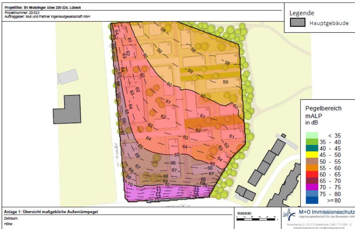
Abbildung 5: Übersicht maßgebliche Außenlärmpegel, Verfasser: M+O Immissionsschutz, Oststeinbek
