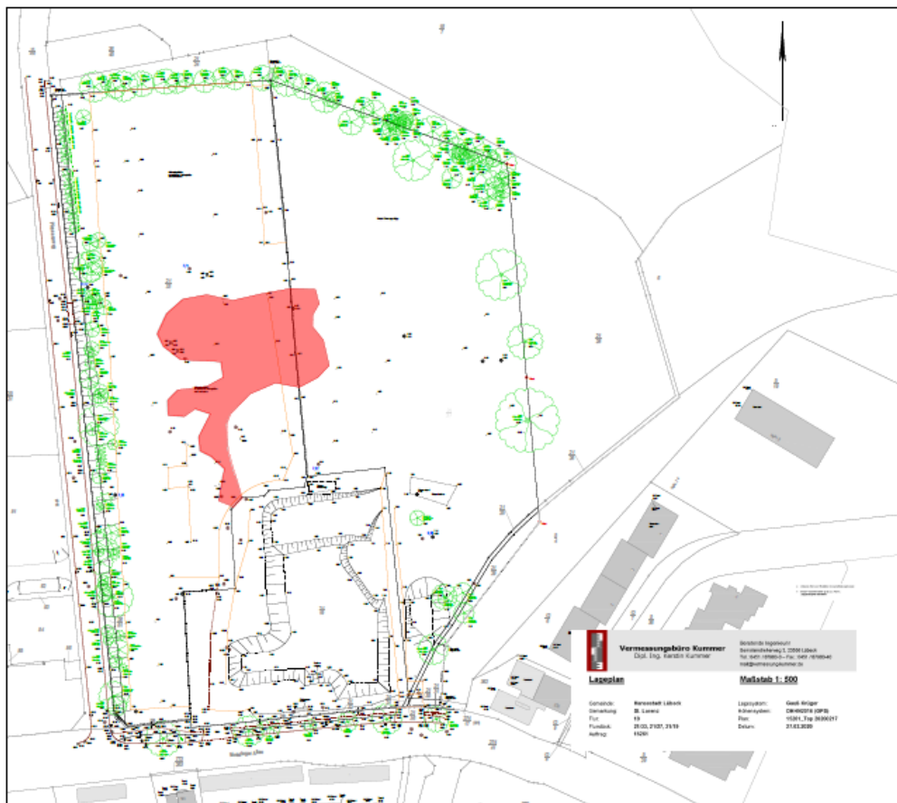
Abbildung 2: Vermessungsplan mit MKW-Schaden, Verfasser: Vermessungsbüro Kummer, Lübeck
