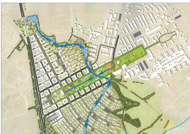
Abb. 16: Hochschulstadtteil Lübeck: Retentionsräume und Notwasserwege für den überschüssigen Regenabfluss bei Starkregen (links: Rahmenplan Grünordnung, rechts: Blick in den Carlebach Park nach einem Starkregen)
