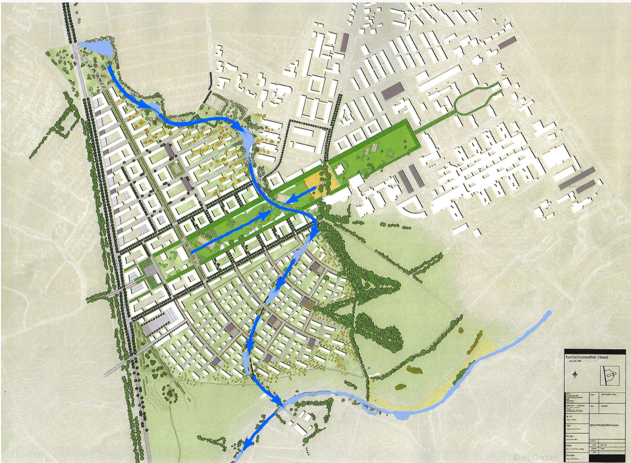
Abb. 23: Hochschulstadtteil Lübeck: Retentionsräume und Notwasserwege für das Oberflächenwasser (Rahmenplan Grünordnung, HEG mbH 2001; bearbeitet)
