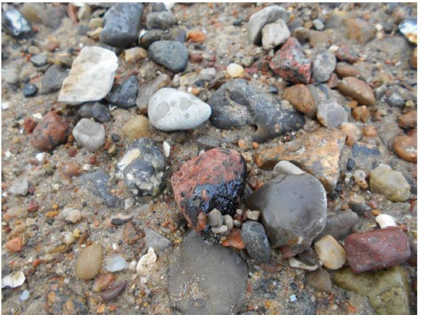
Bild 5, sporadische Öl-Placken als Anhaftung an Steinen.
