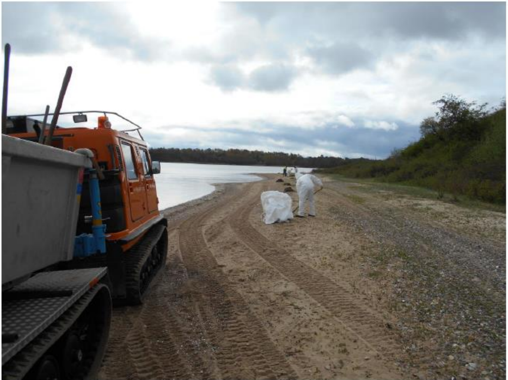
Bild 8, Einbringen ölverschmutzter Seegrasbüschel in Big-Bags zum Abtransport mittels Hägglunds.
