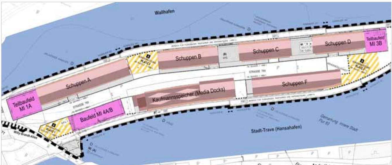
Abbildung unten: Darstellung der Baufelder (hellgrau / pink) der historischen Schuppen (braun) und der öffentlichen Plätze P1, P2, P3 (gelb schraffiert) im Bebauungsplan. Rechte Seite: Die innere Erschließungsachse mit ihrem historischen Gleisfächer. Grafik, Foto: Jörg Sellerbeck
